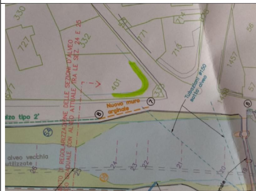
Planimetria di progetto, nella quale è stato indicato il muro già individuato nella planimetria del ponte.
